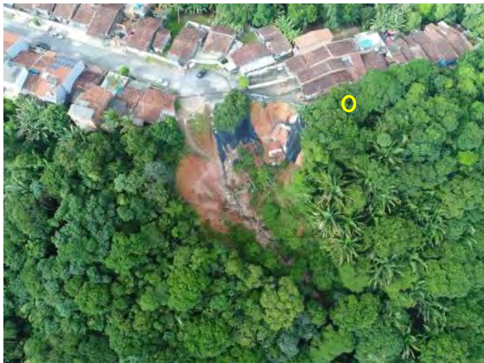
Figura 0.3.- Vista aérea do escorregamento (20.07.22), o círculo indica estreitamento do passeio que dá acesso às edificações localizadas a jusante da rua.
